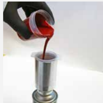
Pour the paint into the Clean-Jector
